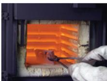
Las operaciones de recocido a altas temperaturas en el aire pueden formar incrustaciones de óxido visibles que se desprenden fácilmente de la superficie. Estas incrustaciones pueden contener óxido de berilio en mayores proporciones que el metal base. Lo más conveniente es controlar la atmósfera del horno para reducir la formación de óxido. Una
