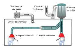
Dentro del sistema de ventilación, el aire residual del proceso debe descargarse al exterior a través un filtro HEPA (siglas de filtros de aire de alta eficiencia para partículas), a una zona donde no exista riesgo de que regrese al centro de trabajo.
